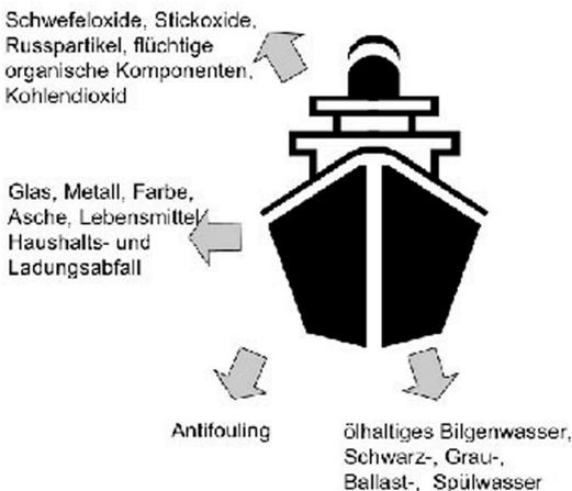
Abb. 5.7-3: Emissionen: Flüssige, gasförmige und feste Emissionen eines Schiffes.
